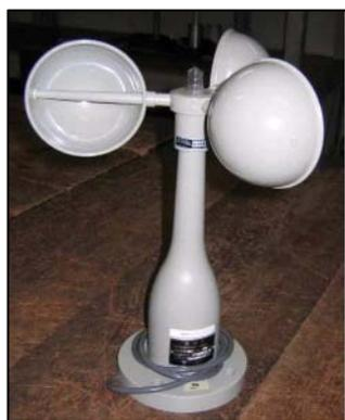
風杯型(3杯式)風速計
