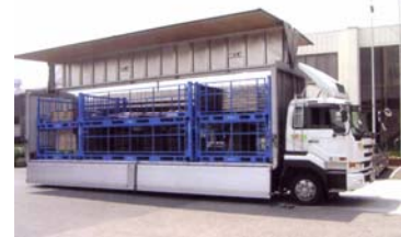
ラックを使用した関東・関西間での トラック輸送効率化実証実験
