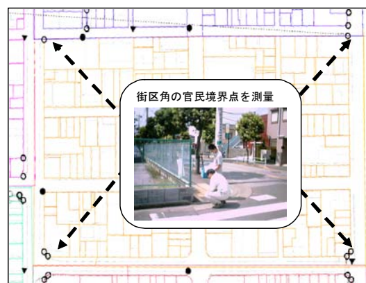
(図3) 街区点の調査
