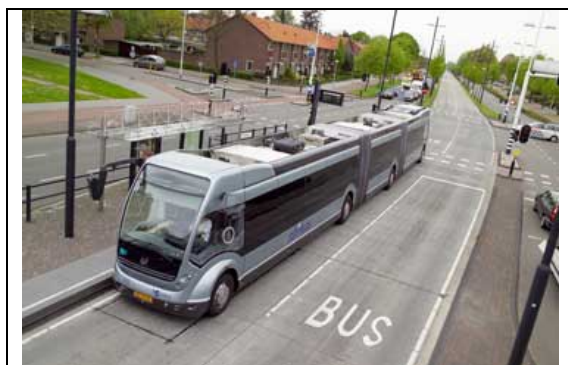
フィリアス3車体連節車。全長 24m~26m。 連節車 (全長 18m) もある。 (APTS フィリアス、オランダ)
