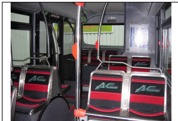
縦握り棒とアシストグリップを一体化した例 (AC トランジット (サンフランシスコ) ベルギー・バンホール社製ローフロアバス)
