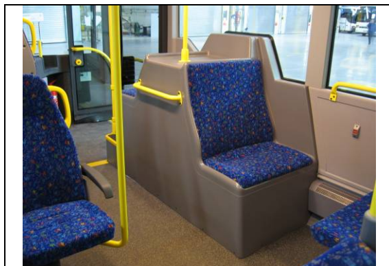
タイヤハウスの後部を背もたれとして使用。 縦握り棒は座席から立ち上がる際にも使いやすい位置に設置している。 (ノルウェー・連節ローフロアバス、ベンツ社製)
