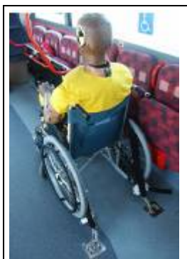
3点ベルト式・前向き固定の事例 2点式シートベルトの装着も必要。 (国土交通省の試作試験車)
