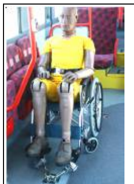
3点ベルト式・前向き固定の事例 2点式シートベルトの装着も必要。 (国土交通省の試作試験車)
