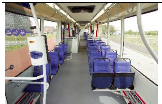
フィリアスの車内。座席は側壁から支持。 ドア開口幅 1,200mm。乗降時の床高 270mm。 (APTS フィリアス、オランダ)
