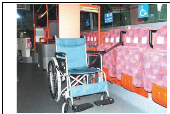
後向き・背もたれ板式 横ベルトで車いすを固定。 (国土交通省の試作試験車)
