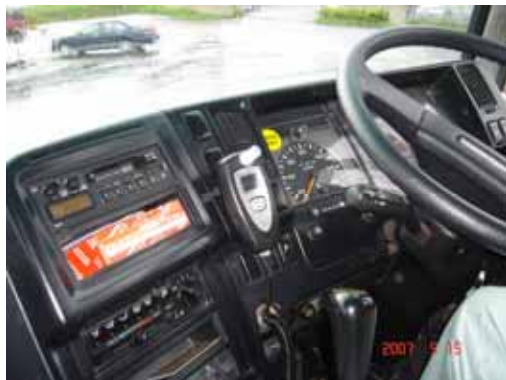
図3 事業用トラックに装備されたアルコール・インターロック装置
