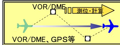
VOR/DME、GPS等からの信号をもとに自機位置を測位し、計算処理して飛行コース等を柔軟に設定可能。
