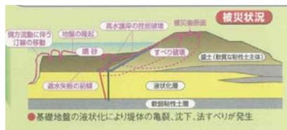
基礎地盤の液状化により堤体の亀裂、沈下、法すべりが発生
