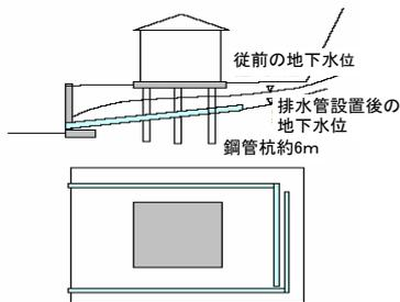
排水管(ドレン)を建物下に配して、地下水位を低減した工法
