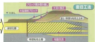
堤体を良質な材料に置き換え、深い液状化層は地盤改良による補強。基礎地盤の液状化による堤体の亀裂、法すべりの発生を抑制
