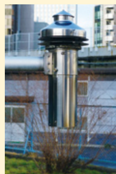
通風筒 断熱材が入った内外二重円筒の構造で、この中に電気式の温度計と湿度計が入っています。さびにくいステンレス製で、内部を直射日光や雨から保護しています。
