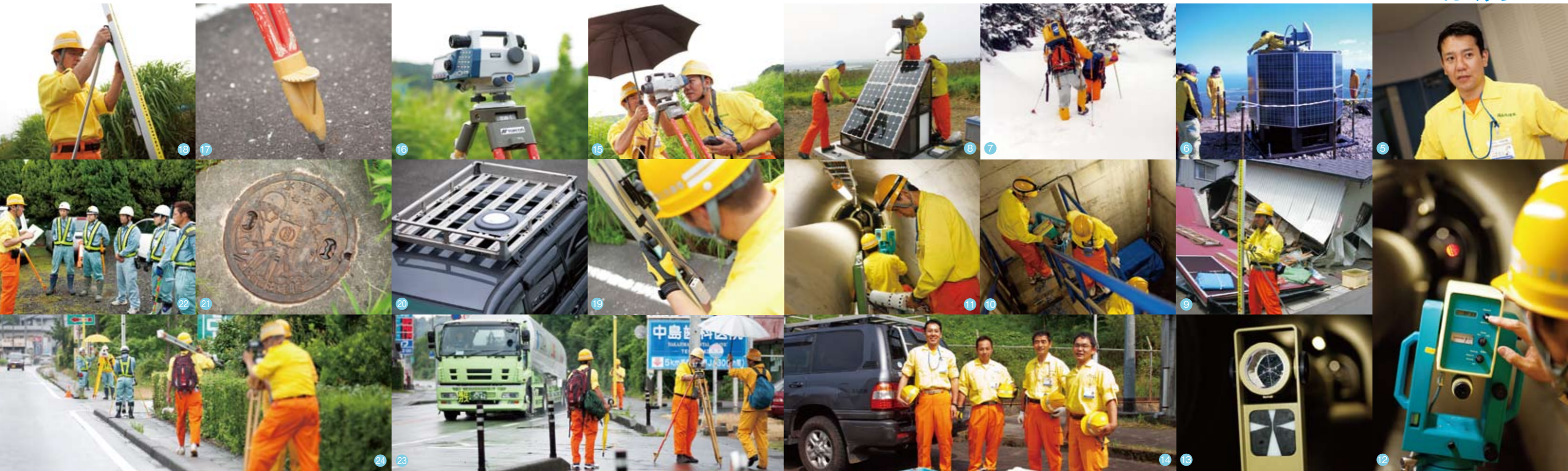
5. 平岡喜文。「信頼されるデータを迅速かつタイムリーに提供し、それが活動のメカニズム解明につながり、最終的に国民の安心・安全につながるこれが、この仕事のやりがいです」 6. 平岡が心血を注いだレグモス。写真は北海道駒ヶ岳での設置風景 7. レグモスのメンテナンスのため、機材を背負い雪山に行く 8. 硫黄島でのレグモス設置時のショット。頻りにメンテナンスに行ける場所ではないので、細心の注意を払って作業 9. 地震発生時の緊急水準測量のショット 10. 11. 地下へ機材を移動し、メコメーターと各種観測機器を設置 12. メコメーター本体。1 キロ先の反射鏡に向けてレーザー光を照射 13. 反射鏡部分 14. 機動観測チームの面々。現場の技術は日々受け継がれている 15. 新型機器を使った試験測量。左手に持つ電算機は Bluetooth でつながっている。頭上の傘は、人間のためではなく機器の誤差をできるだけ減らすため 16. 国内メーカーと共同開発した電子レベル 17. 測量用三脚は一般的な三脚とは異なり、地面に突き刺さるようになっていて 18. 19. 標尺手は手元の水準器を常に見つめている 20. 機動観測車両の屋根に付けられた丸い物体は衛星電話用のアンテナ。内部でアンテナ部分が回転している 21. 水準点のカバー。日本列島と測量士がデザイン化されている 22. 監督中の平岡。水色のユニフォームに安全ベストを着用しているのは民間会社チーム 23. 24. 交通量の多い道路に沿って測量を実施。安全に気を配りながら素早く移動して行く
