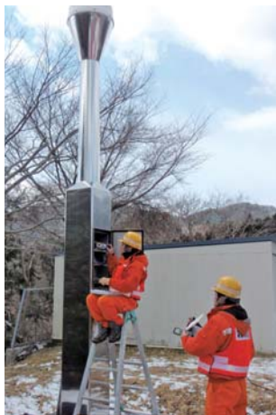
震災後、直ちに行われた電子基準点のデータ回収と点検作業。
