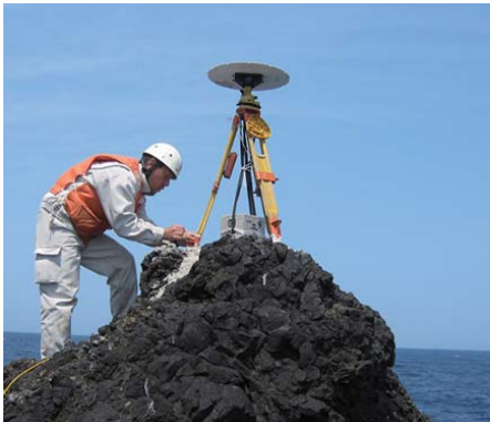
青森県・久六島(きゅうろくじま)での三角点設置。領土・領海の正確な明示や島の保全・管理のため、離島においての三角点の新設や再測量も行われている。
