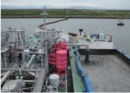
泥艙に溜まった土砂を中継ポンプ台船「輝龍」に移す。奥に見えるのは、土砂処分場のポートアイランド。
