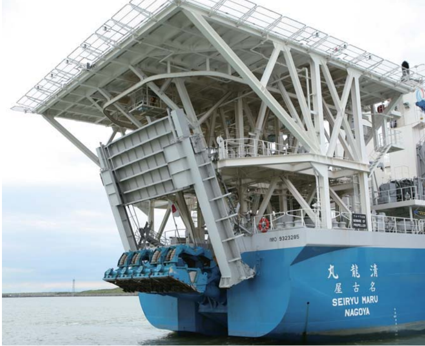
船尾に装着されている掃除機のノズルのようなドラグヘッドは、幅7.2メートル。
