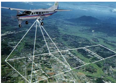
空中写真撮影を行う測量用航空機「くにかぜⅢ」。機体内部には大型カメラを設置。エリアごとに撮影を繰り返す。
