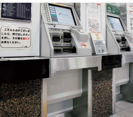
下部に車いすの方が切符を購入する際、ひざなどが当たらないよう配慮されたユニバーサル券売機。低いタッチパネルは小さな子どもも手が届く。
