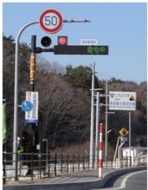
津波浸水想定区域には、以前から津波標識を設置していた。昨年2月、先行的に宮古市で「津波警報板」を設置し始めたその約2週間後に地震が発生。「津波警報が発令された時に、通行中のドライバーや歩行者にその情報を同時に提供し、自主的な避難を促すことが重要。津波警報板の整備を進めています」(渡邊)
