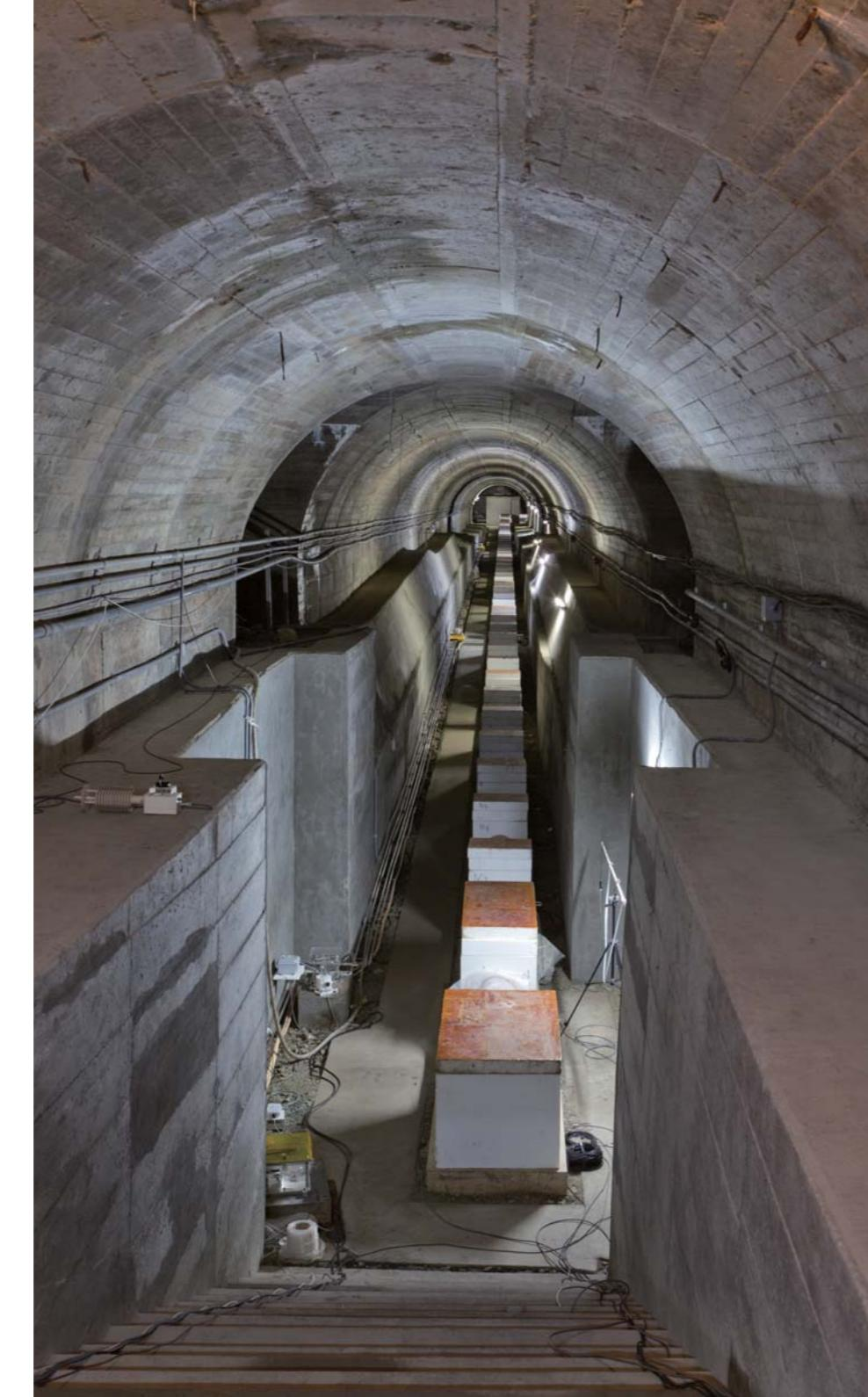
大抗道内の歪地盤計。白く見えるのは水平方向の歪みを検知する石英管を支えている部分。歪地盤計の左に平行して見えるのが、上下方向の歪みを検知する水管傾斜計の長い管。
