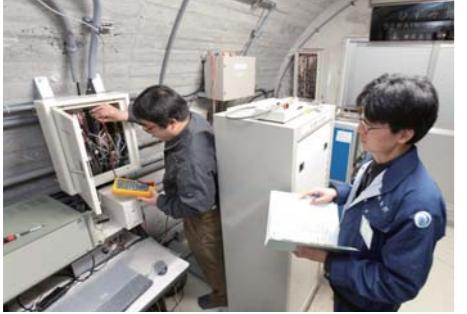
歪地盤計のセンサーからの出力電圧をチェック。年に数回のメンテナンスは不可欠だ。
