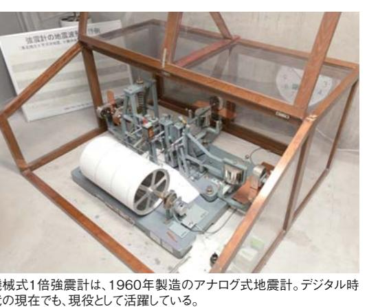
機械式1倍強震計は、1960年製造のアナログ式地震計。デジタル時代の現在でも、現役として活躍している。
