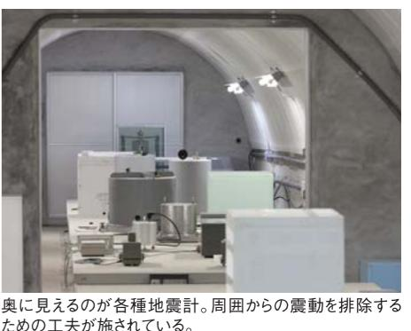
奥に見えるのが各種地震計。周囲からの震動を排除するための工夫が施されている。
