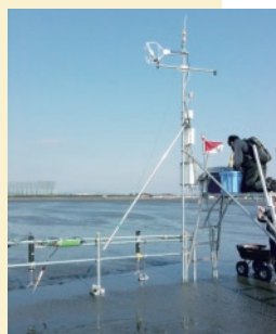
CO 2 吸収速度を観測する装置
