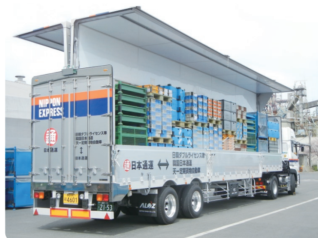
ウイングシャーシ。鳥の翼のように上下に開く構造のため、貨物の搬入を短時間で行うことができる。
