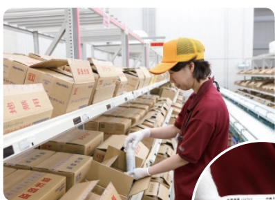
3階の荷揃えエリア。専用端末から荷揃え用のラベルが発行されると、同時に該当商品が置かれている棚に赤いランプが付く。それに合わせて専門の作業員が手作業で品物を揃えていく。
