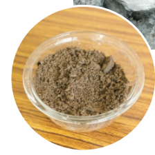
粘性土に混ぜる砂質土。漁川のダム工事で採取したものを利用する。
