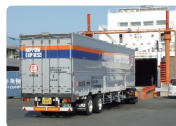
RORO 船に直接積み込まれるシャーシ。トラクタヘッドは日韓両国で、それぞれの国の車両を使用する。
