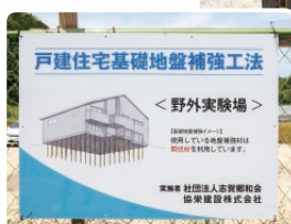
放置されている細い間伐材で基礎地盤補強工法を開発中
