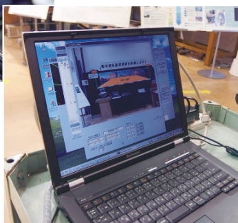
LED灯器は2対になっている。灯器からの発行信号をカメラで撮影（写真上）すると、パソコンの画面のような情報が表示される仕組み。
