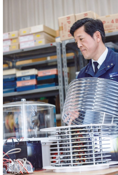
次の試作器を制作中。今度の灯器はLED9段、1万カンデラ（光の強さを表す単位）に。
