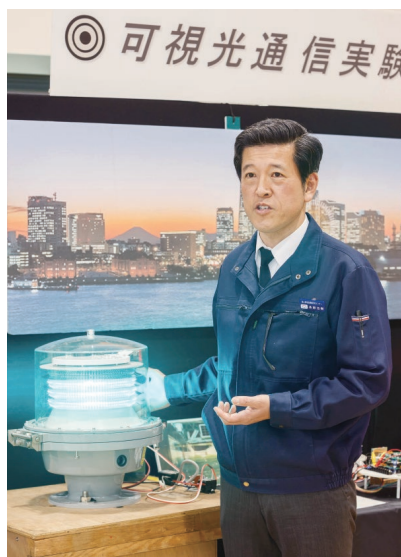
平成26年1月の可視光通信実験で使用したLED灯器
