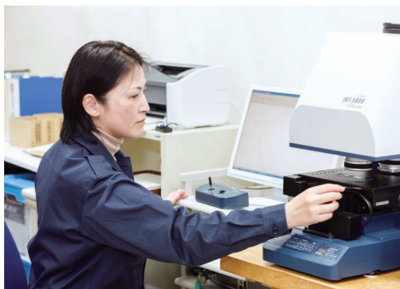
赤外分光分析をかけ、外観が類似している各塗膜層を比較する。
