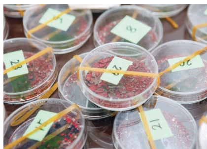
船舶の部位別に採取された塗膜片のサンプル（写真下）の断面を顕微鏡で拡大観察しながら一つずつ分析している。
