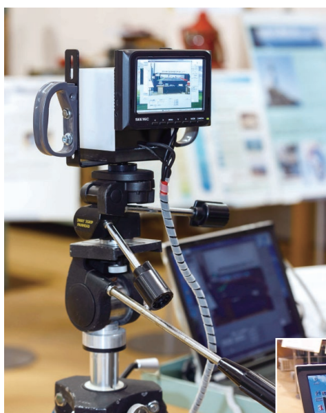
LED灯器は2対になっている。灯器からの発行信号をカメラで撮影（写真上）すると、パソコンの画面のような情報が表示される仕組み。
