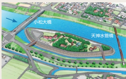
分水路イメージ図。国の重要文化財に指定された小松天満宮(中央)を保存することを目的とした改修を実施
