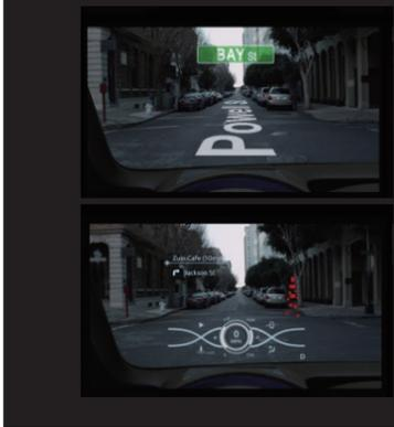
「車内外」のさまざまな情報と、フロントガラス全体を透過モニターに活用する既存の技術が合わされば、例えば道路の名称や、街路樹に隠れた標識、センサーで検知した歩行者などが視界に自然と表示されることも可能になる。またリアルタイムで変化する動的情報が加わると、道の混雑状況、駐車場の空き状況といった情報も確認しながら運転できるようになる。
