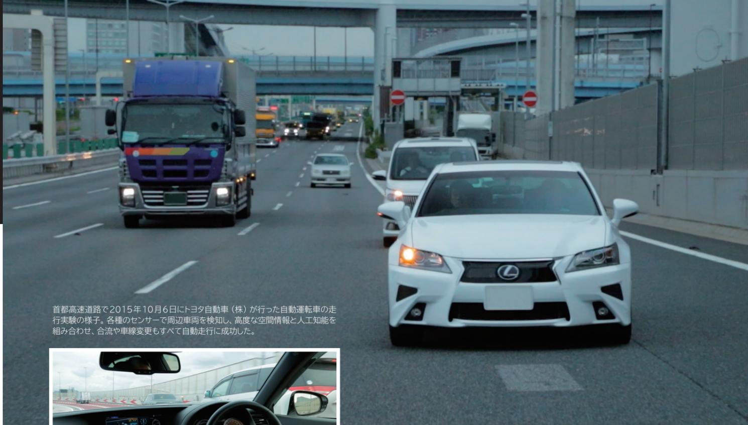
首都高速道路で2015年10月6日にトヨタ自動車(株)が行った自動運転車の走行実験の様子。各種のセンサーで周辺車両を検知し、高度な空間情報と人工知能を組み合わせ、合流や車線変更もすべて自動走行に成功した。
