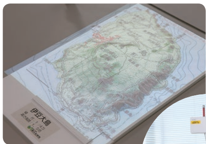
何も描かれていない白い立体地図にプロジェクションマッピング方式で投影。ライブラリーで公開されているデータをさまざまな方法で活用できる
