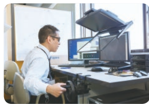
デジタル立体図化機。専用眼鏡をかけると写真が立体に見える、地形に沿いながら描き起こしていく。ただし操作方法は以前のもので変わらずハンドル操作する
