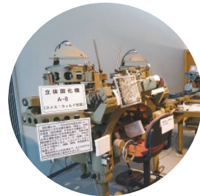
地図を描くのに以前実際に使われていた立体図化機。現在は「地図と測量の科学館」内に展示されている
