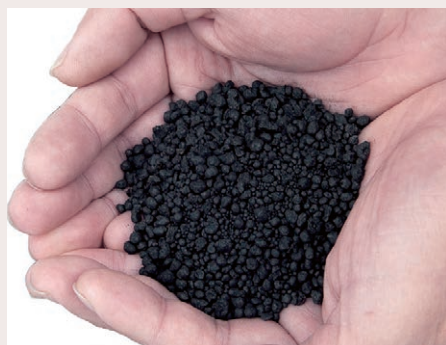
下水汚泥から作られた固形燃料
