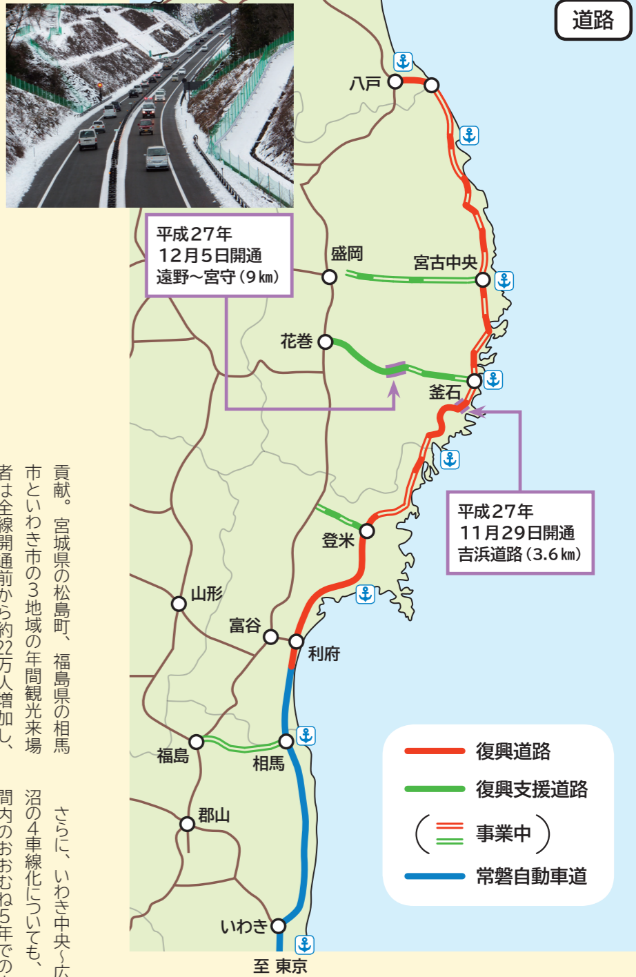
震災の経験を踏まえ、沿岸を走る復興道路の95%が津波浸水区域を回避。通過が必要な5%では橋梁で十分な高さを維持し、当時と同レベルの津波でも寸断されない強固な防災機能を持つ。
