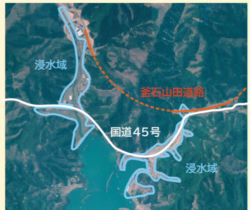
震災の経験を踏まえ、沿岸を走る復興道路の95%が津波浸水区域を回避。通過が必要な5%では橋梁で十分な高さを維持し、当時と同レベルの津波でも寸断されない強固な防災機能を持つ。
