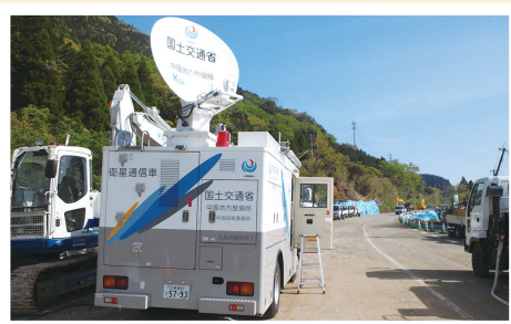
衛星通信車による画像伝送支援(阿蘇大橋付近)
