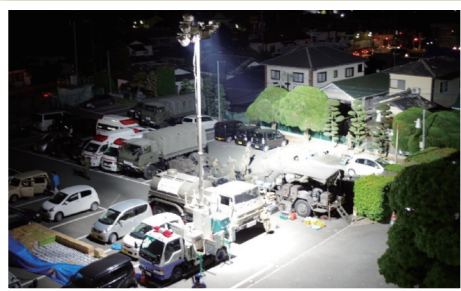
照明車により夜間作業を支援(益城町)
