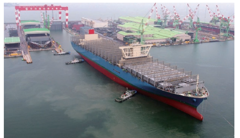
新ドック完成と同時に進水する長さ400mの20000個積みコンテナ船
