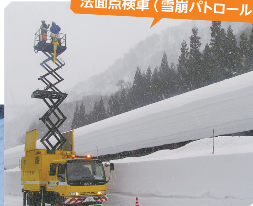
雪崩パトロールでは法面点検車を使って雪崩の危険箇所を異常がないか点検する。
