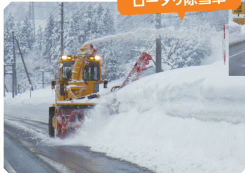
雪が降りつづく中、ロータリ除雪車で路肩の雪を取り除く。
