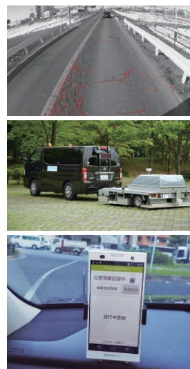
写真は現在提供中の各社のサービス。(上)「舗装ひび割れ自動解析サービス」(東芝)、(中)チャープレーダを用いた「路面下空洞探査サービス」(川崎地質)、(下)「道路パトロール支援サービス」でのスマホ画面(FTRD)
