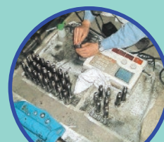
遊戯施設の探傷試験
