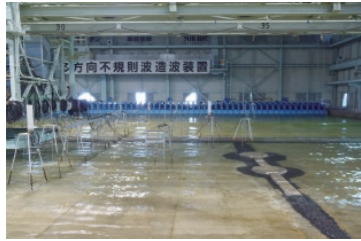
最も大きな平面水槽B。消波ブロックも実物のミニサイズを使用。
