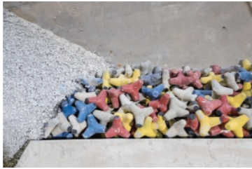
最も大きな平面水槽B。消波ブロックも実物のミニサイズを使用。
