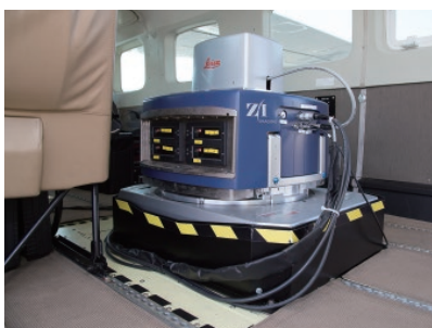
機内に設置された空中写真撮影用のデジタル航空カメラ
