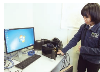
4個の記録装置に分けて保存したデータをこのパソコンにダウンロードし、1枚の写真に合成します
