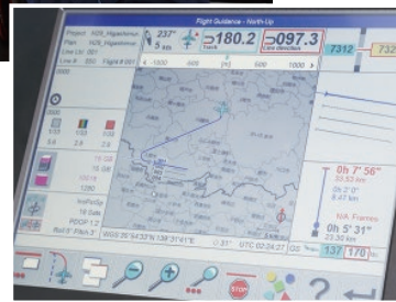
機内に設置されているモニターには、今回 撮影する地区の計画が表示されており、現在 位置もリアルタイムで表示される。このモニ ターを見ながら撮影記録を取っていく。
