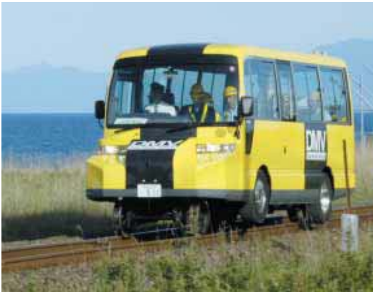
JR北海道によるDMVの走行試験
