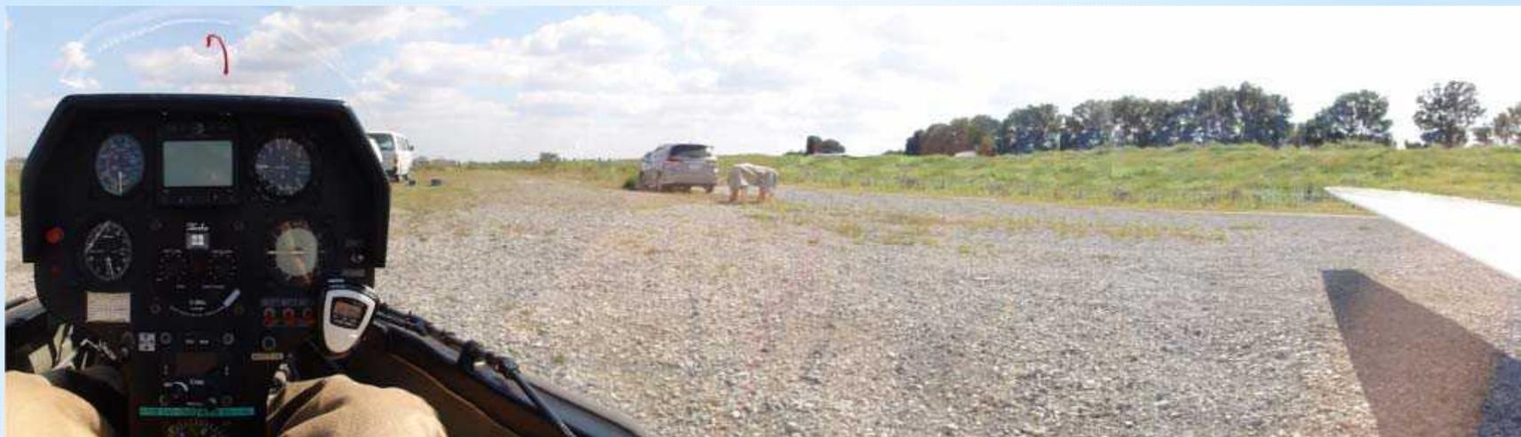
**左右及び前方上側の視界は良好であるが、座席が後傾しているため、前方下側の視界は床及び計器盤に遮られて不良である。**
