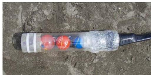
写真 - 2 間隙水圧計
