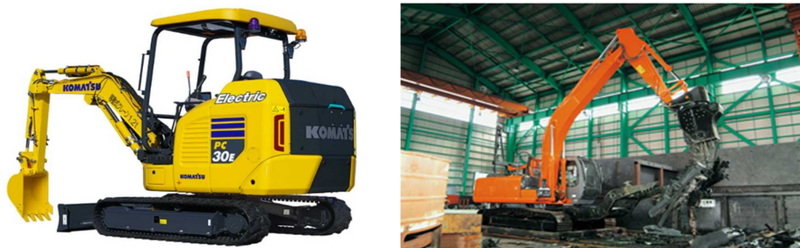
図 4.2.2 工事車両の電動化
