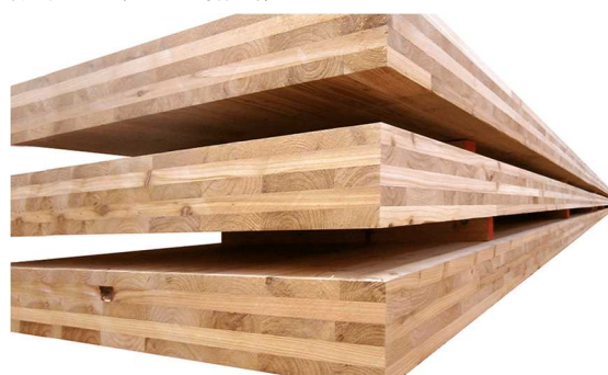
図 4.1.4 CLT(直交集成板)
