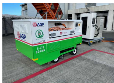
写真 5.1.2 移動式 GPU(牽引・バッテリー駆動式)
