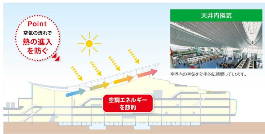
図 5.7 天井換気システム
