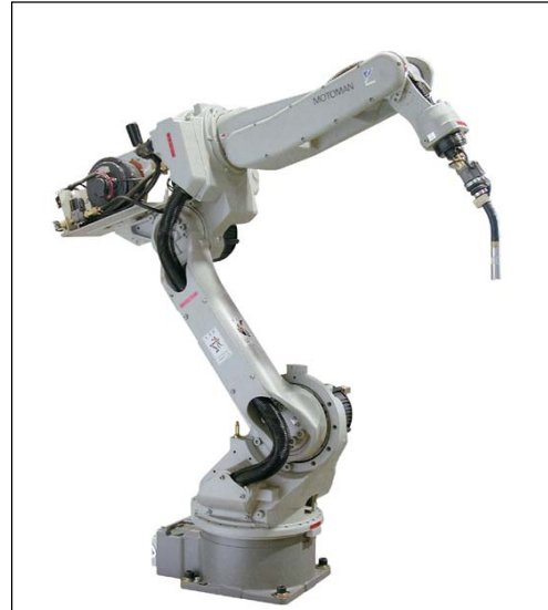
自動車溶接用 6 軸垂直多関節ロボット
