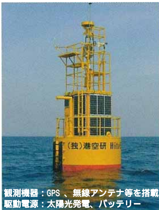
図 -2-1 GPS 波浪計の写真および概略図
