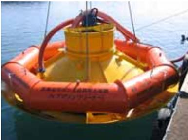
図表 3-25 . 剥離密閉吸引式底質除去装置
