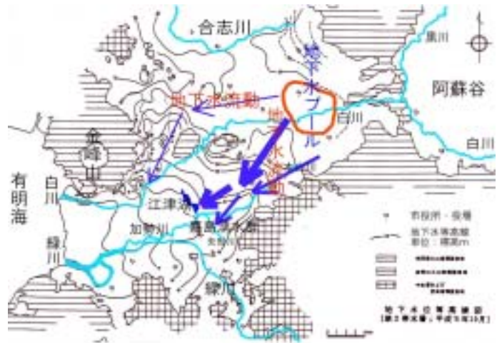
図序-2 熊本地域地下水の流れ[1]
