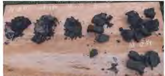
付録写真-2.8 深度毎の掘削土砂。A.P. -8.14m (左上) からA.P. -12.59m (右下) までの推移
