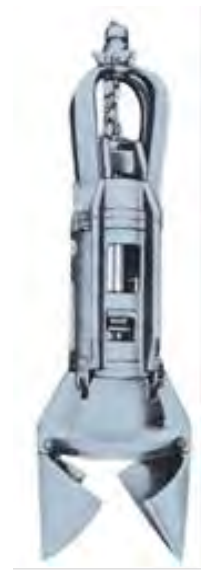
写真 2-1 ハンマーグラブによる掘削状況及びハンマーグラブ本体の写真
