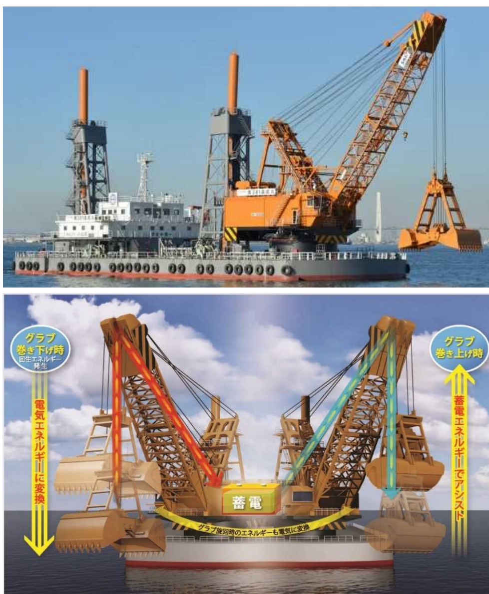
図 54:上)第 381 良成丸 下)ハイブリッドシステムの概念図
