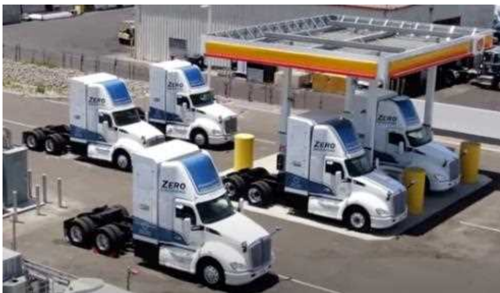
図 15 :LA/LB 港を拠点に貨物輸送を行う大型 FC トラクターヘッド
