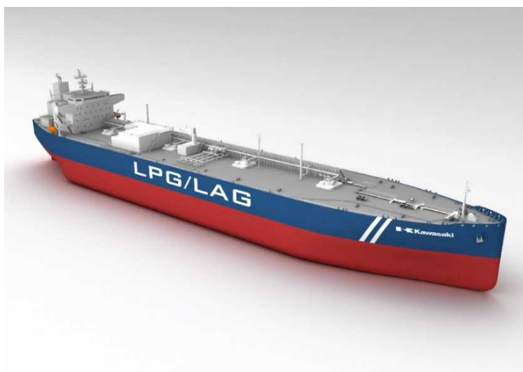
図 29:LPG 燃料 LPG/アンモニア運搬船のイメージ図
