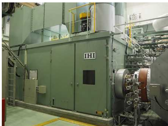
図 39:左)2,000kw 級ガスタービン試験設備 右)ガスタービンコージェネレーションの概要
