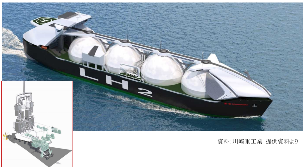
図 19:大型液化水素運搬船と大型水素推進システムのイメージ図
