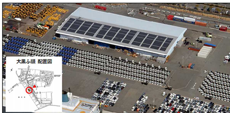
図 8:神戸港の荷捌場上における太陽光発電導入事例
