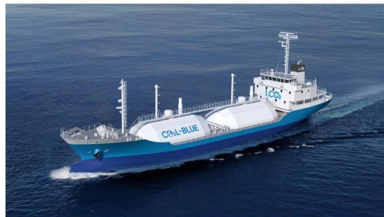
液化CO 2 輸送の実証試験船のイメージ図 (提供: 三菱造船株式会社)
