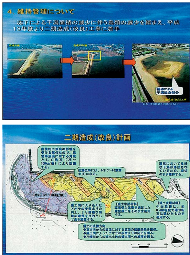
図 2.1.13 五日市干潟での二期改良工事例
