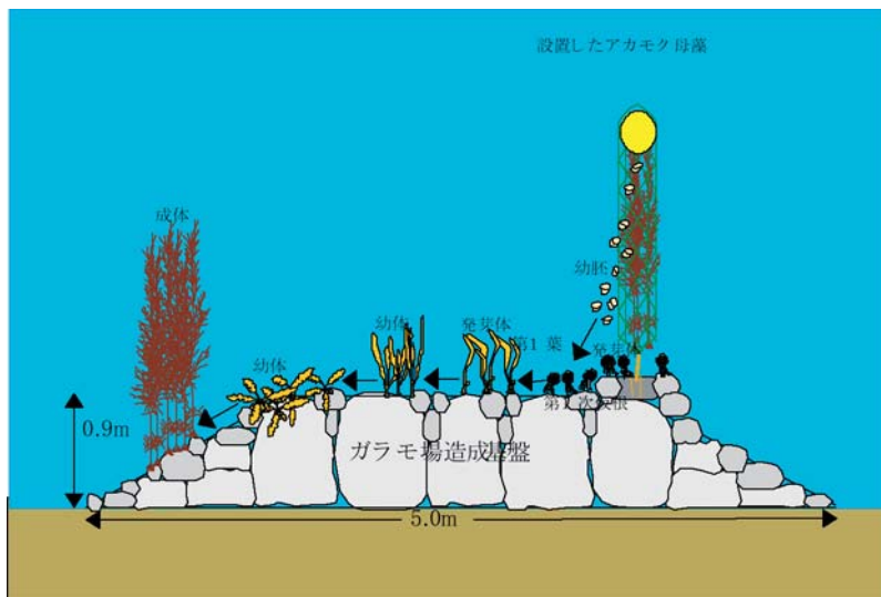
図 2.2.7 アカモクの母藻投入手法と生長状況調査例 1)
