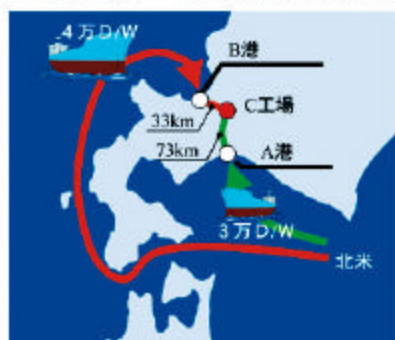
▲B港における多目的国際ターミナルの整備により、4万D/W級の大形船（従来はA港で3万D/W級）が入港可能に、また港から工場までの陸上輸送距離も短縮されC工場の物流コストが年間16億円削減される見込み。
