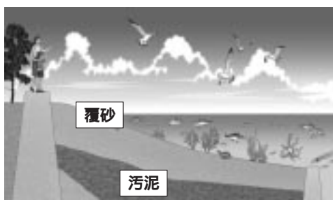
汚泥上に良質の土砂を覆砂することにより、有害物質の溶出を防止
