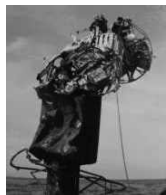
損傷した浮体式灯標
