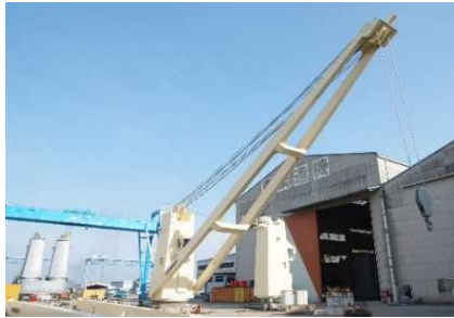
デッキクレーン
