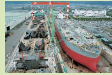
岸壁につないだ状態で、船内の工事を行います。艀装工事は進水後だけでなく、進水前にも行われます。
