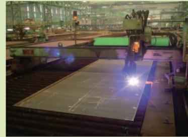
設計情報に基づき鋼板を自動切断します。
