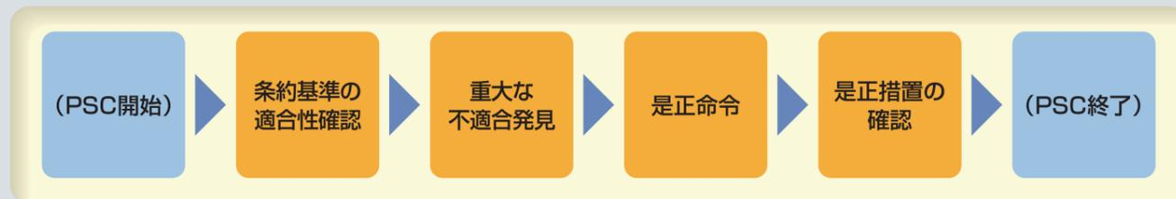
PSCの検査は、条約証書の確認、船体構造の健全性、救命・消防設備、海洋汚染防止設備、船員の資格証明書及び船舶の保安の確保等について国際条約に基づき検査を行います。
