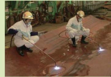
船の先端部など複雑な部分の曲面はガスバーナーの炎と水だけで人の手によって造られます。
