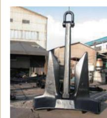
船舶を一定の場所に泊めておくためのものが錨です。錨が海底をかく力と錨鎖が海底に横たわることによる摩擦力により、船舶が風や波浪で流されることを防いでいます。
