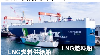
LNG燃料供給船 出典：セントラルLNGマリンフューエル
