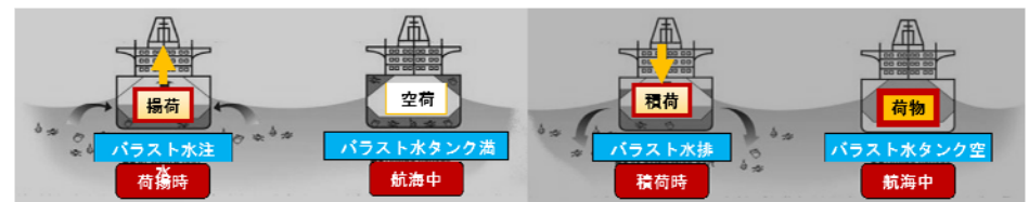
図表 II - 5 - 5 バラスト水の機能
