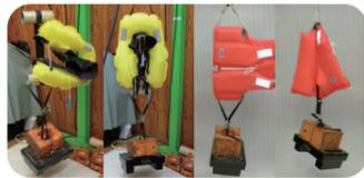
ライフジャケットには、救助時の引き上げなどに耐えうる強度が必要です。縦と横の2方向それぞれに、大人用は荷重880N(約90kg)、小児用は580N(約60kg)を30分間加え、損傷しないことを確認します。
