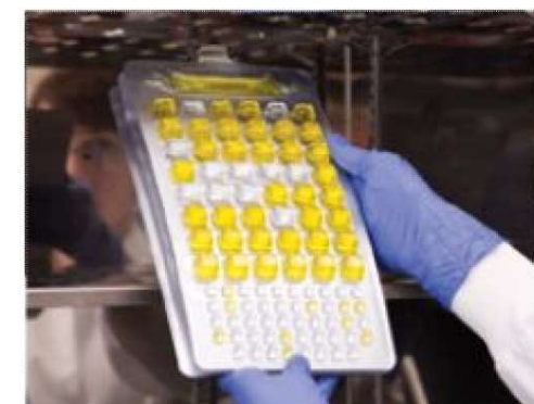
写真-4 大腸菌群と大腸菌 (QTトレイによる最確数法:コリラート)
