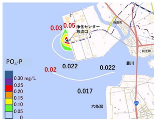
図6 リン酸態リン（PO 4 -P）の分布結果の一例-豊川浄化センター周辺海域
