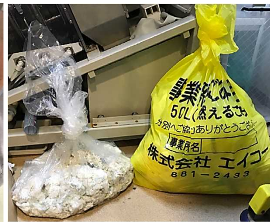
図 処理装置で破碎した使用済紙オムツ(左)と未処理の使用済紙オムツ(右)
